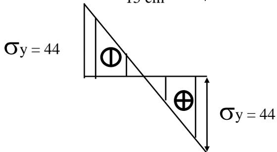
Los signos de  $\sigma_y$  se sacan saliendo de un triángulo de  $\sigma_x$  con una horizontal hasta la línea de fuerzas, continuando con una vertical hasta llegar a un triángulo de  $\sigma_y$  que tendrá el mismo signo que el de  $\sigma_x$ .
